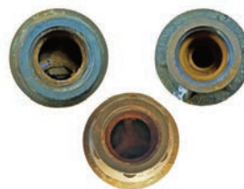
Entrada e saída de reguladores de pressão desgastados.
