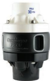
La PRXF-LV (válvula de límite de flujo extendido reguladora de presión) de Senninger está diseñada para utilizarse en lugar de los reguladores de presión estándar para limitar la presión estática (sin caudal) del agua cuando se utiliza una válvula de cierre aguas abajo del punto de regulación.
