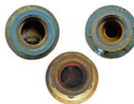
Entrée et sortie de régulateurs de pression usés.
