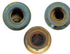
Впускные и выпускные отверстия изношенных регуляторов давления.
