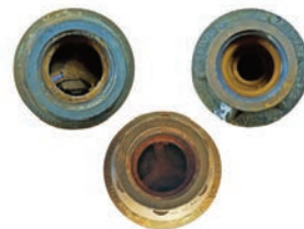
Einlass und Auslass von abgenutzten Druckreglern.
